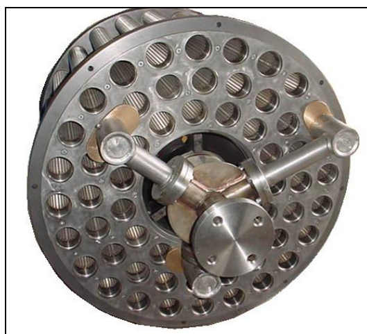
Detalhe interno dos elementos filtrantes
